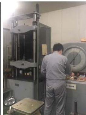
製造本部内の破断試験機
