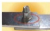
パルプが形成された締結後の部材の状態
